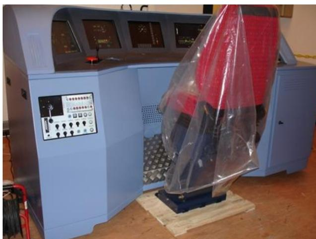
Ce type de simulateur est développé principalement lorsqu'il y a plusieurs types d'engins à simuler.
