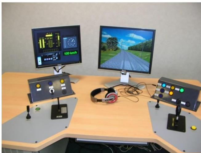
Ce type de simulateur est développé sur un modèle de train générique sur lequel il est adapté notamment les capacités d'accélération et de freinage du train devant être simulés. Les affichages peuvent être mis en adéquation avec l'engin réel.
