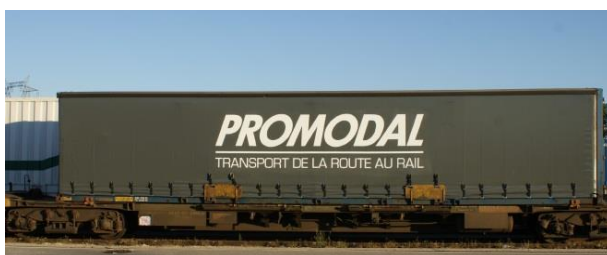
Exemple de caisse mobile plateau
