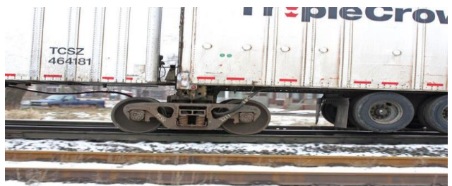
Exemple de Road-Railer
